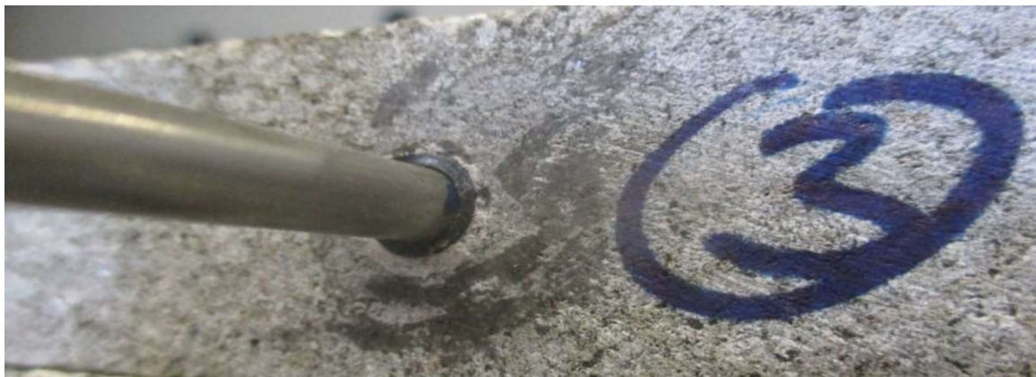
Bild: Ankerdorn in Gleithülse
